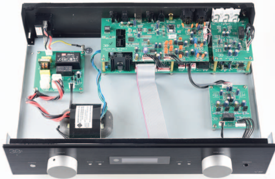
Durch ihre geringe Ausgangsimpedanz kann die V30-Vorstufe auch längere Leitungen zu den Endstufen locker treiben. Dennoch bleibt zu überlegen, die Monos trotzdem zum Vorverstärker zu stellen: Lange NF-Leitungen sind viel empfindlicher als lange Lautsprecherkabel.
