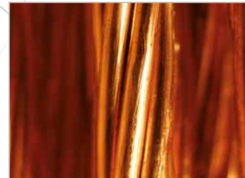
Die Übertragung von Tonsignalen ist anfällig für viele Störungen: Widerstand, Induktivität, Kapazität, Leitwert der Isolation und Skin-Effekt beeinflussen den Klang negativ. Das Material der Leiter hat dabei eine große Bedeutung. Denn jede Verunreinigung im Leitermaterial behindert den Stromfluss, verschlechtert den Leitwert und erhöht das Grundrauschen. In unseren Referenz Kabeln verwenden wir deshalb nur besonders reines, sauerstofffreies Kupfer (OFC) mit einem hohen Leitwert.
