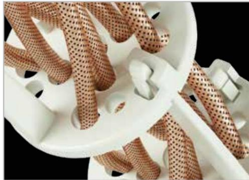
Die Erkenntnis, dass Lautsprecherkabel in erster Linie eine geringe Induktivität haben sollten, wird beim LS-2404 AIR optimal umgesetzt: Durch die zweilagige Anordnung des Double Layer Multicores überlappen und neutralisieren sich die um die einzelnen Leiter entstehenden Magnetfelder. Dies reduziert die Induktivität des Kabels erheblich und auch die hohen Tonfrequenzen werden ungehindert und ohne Zeitversatz transportiert.
